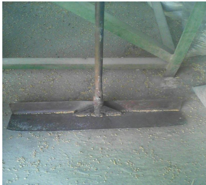
Pala utilizada para la tarea de limpieza de los silos.
