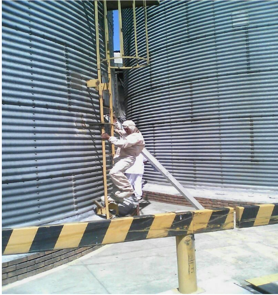
Procedimiento de entrada al silo por parte de un trabajador.
