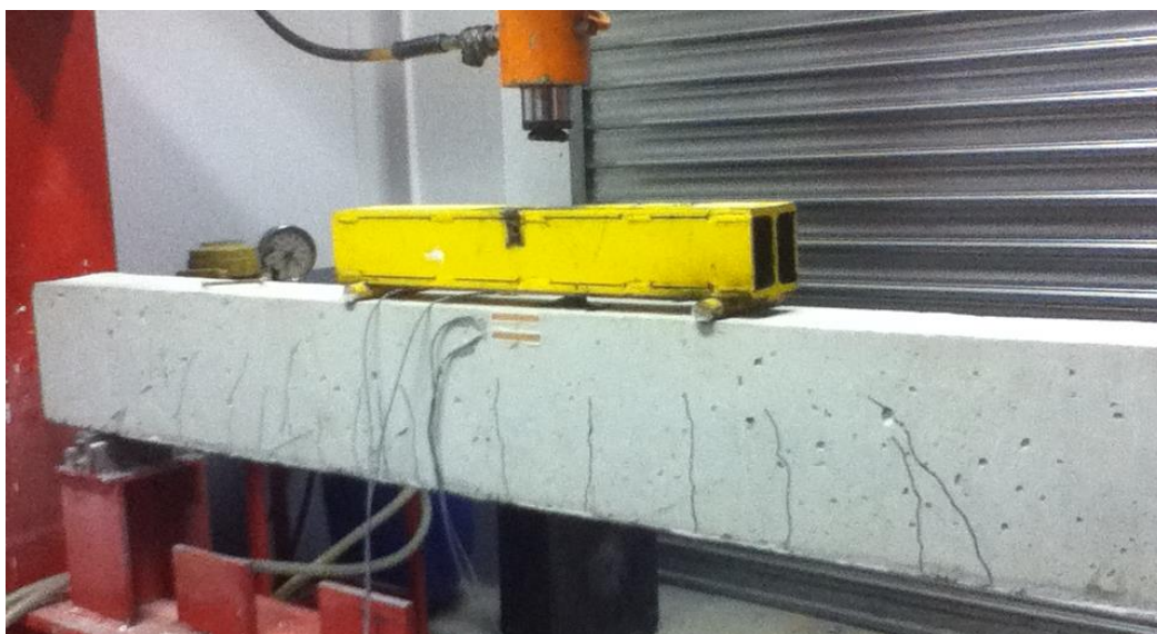
Photo 2.8. Chargement de la poutre renforcée par TRC avec joncs de carbone
