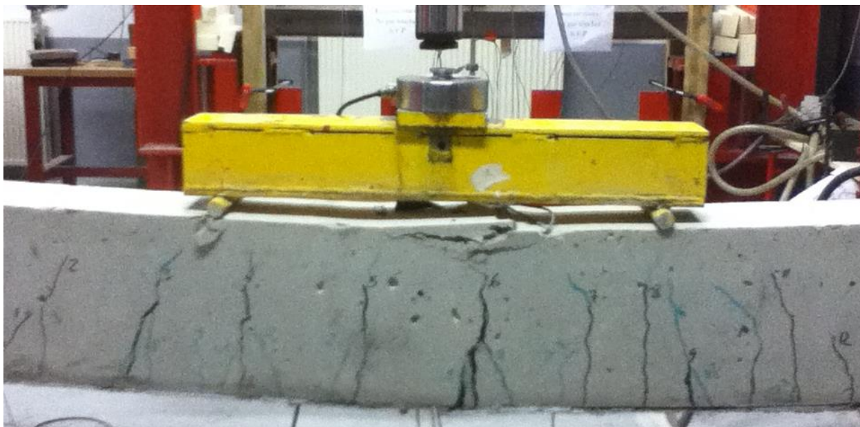
Photo 2.9. Mode fissuration de la poutre après renforcement
