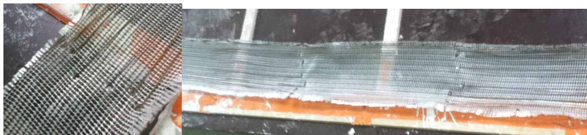
Photo 2.5. Tissage des joncs dans le tissu
