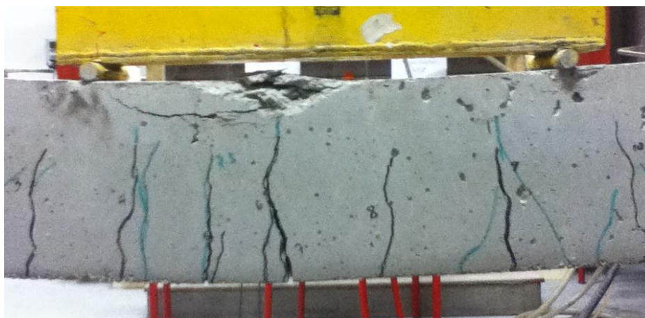
Photo. 2.13. Distribution des fissures de la Poutre Pas Renforce (P4)
