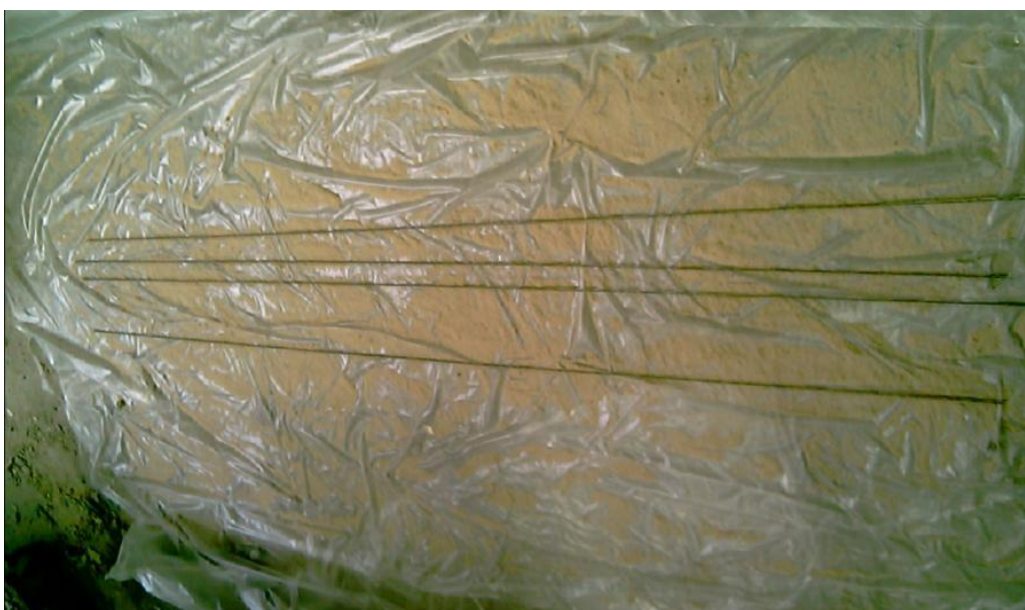
Photo 2.4. Roulage dans le sable après imprégnation
