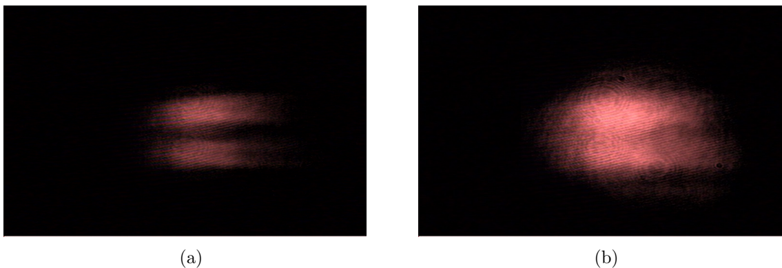
Figura 4.13: Perfil do feixe de prova transmitido usando a transição de (a) EIA e (b) Bombeio colocando um ângulo entre os feixe de prova e acoplamento para o formato de linhas horizontais.
