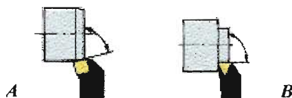
Figura 24. Operación de Refrentado con diferentes ángulos de posición: (A) 75° y (B) 90.°
