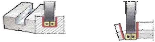
Figura 30 . Diagrama de las operaciones de ranurado y tronzado. Detalles de de superficies con fresas frontales.
