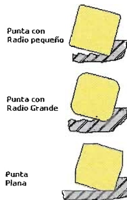
Figura 42. Diferentes rugosidades de superficie para varios tipos de puntas en la geometría de la herramienta.
