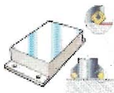
Figura 29 . Detalle de planeado de superficies con fresas frontales.
