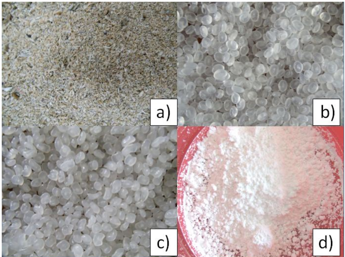
Figura 4. Materiales utilizados en la elaboración del CPM: a) partículas de madera, b) polipropileno virgen, c) anhídrido maléico de polipropileno, d) borato de zinc.
