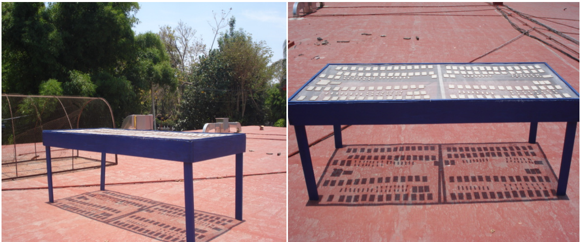
Figura 10. Especímenes de CPM expuestos a intemperismo natural en las instalaciones del Departamento de Madera, Celulosa y Papel.
