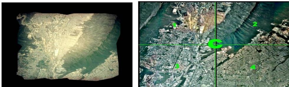
Figura 5.5.1.- Imagen digital aérea para ortorectificar (A). Imagen digital ortorectificada (B).
