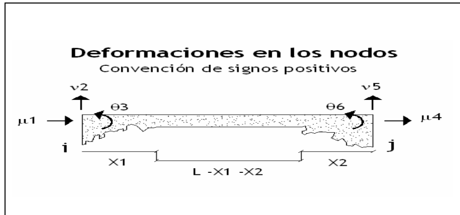
Fig. 2.2 Elemento de eje recto acartelado con las deformaciones asociadas a los sentidos de los grados de libertad. (Reiley y Estévez, 2006)
