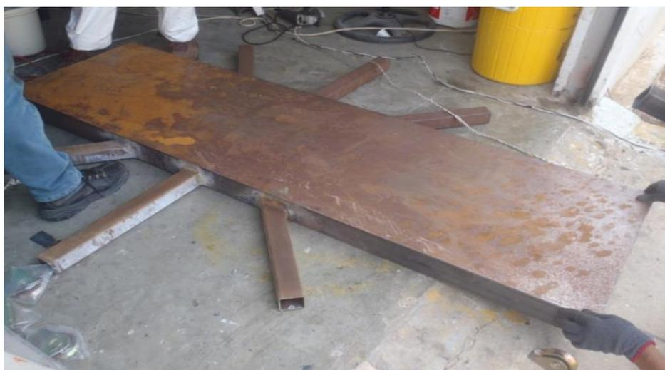
*Imagen 13. Base de la máquina paletizadora.* Fuente: Propia, (2013).
