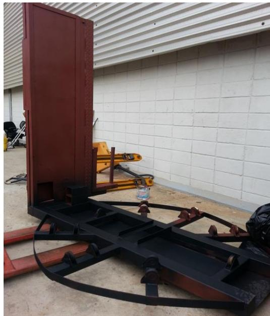
*Imagen 20. Máquina paletizadora con el fondo aplicado.* Fuente: Propia, (2013).
