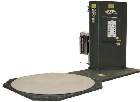
*Figura 7: Máquina Envolvedora de Plataforma Giratoria Wulftec.*
