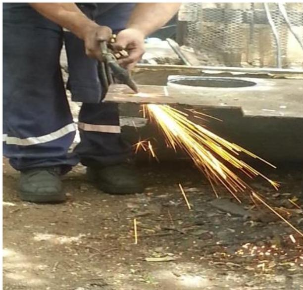
*Imagen 31. Corte de plancha para bases de rodamiento.* Fuente: Propia, 2013.
