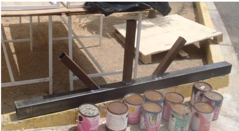
*Imagen 11. Resultado de la soldadura de brazos al bastidor.* Fuente: Propia, (2013).
