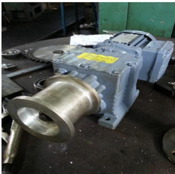
*Imagen 34. Tambor acoplado al motorreductor.* Fuente: Propia, (2013).
