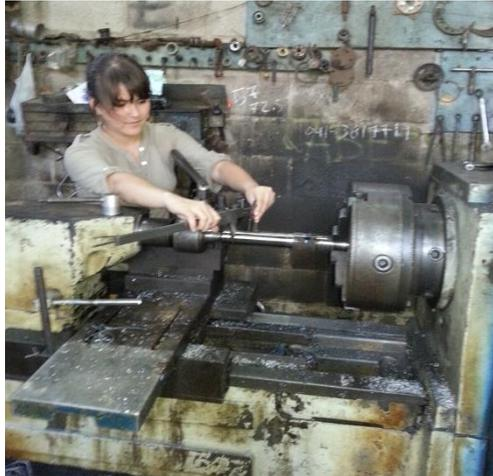
*Imagen 24. Verificando medidas del eje.* Fuente: Propia, (2013).
