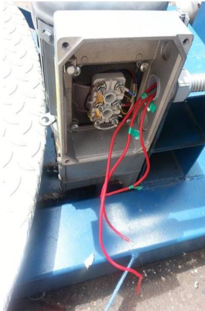
*Imagen 44. Identificación de los cables a la conexión de los motores.* Fuente: Propia, (2013).
