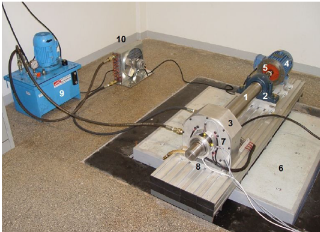
Figura 2.2. Bancada experimental do MHA: (1) Eixo, (2) mancal de rolamento autocompensador, (3) mancal hidrodinâmico com atuadores embarcados, (4) motor elétrico, (5) junta universal, (6) mesa inercial, (7) sensor de proximidade, (8) mancal de excitação, (9) unidade hidráulica, (10) sistema trocador de calor.
