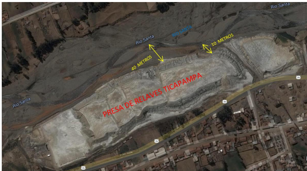
Figura 4.5 Ubicación y distancia entre la presa de Relaves de Ticapampa y el río Santa.
