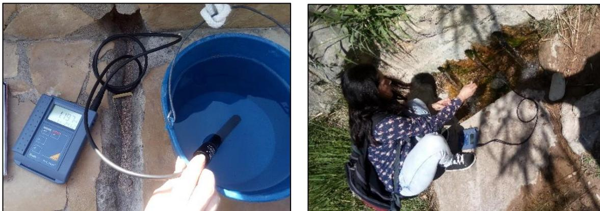
**Figura 4.16.** Medición de temperatura del manantial termal Montanejos in situ
