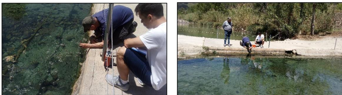
**Figura 4.17.** Vista fotográfica de aforo del río Mijares en el tramo final de Montanejos
