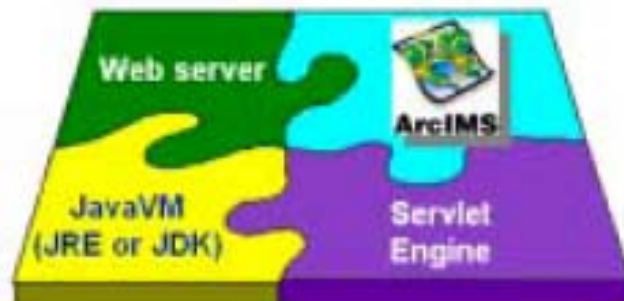
Figura 3.2. Componentes necesarios para ArcIMS
