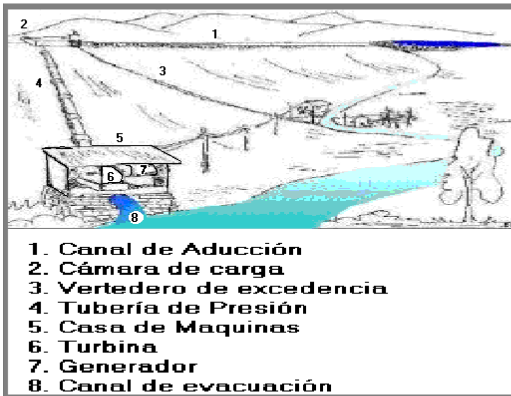
Figura 3. Esquema general de una microcentral hidráulica
