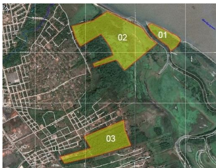
Figura 8: Se representa com o número 01 à área destinada ao Terminal Aquaviário, com o número 02 à área destinada ao Terminal Graneleiro, e com o número 03 à área onde iria se localizar o Pátio Regulador de Carretas. Fontes: EMPRAS/Apresentação.
