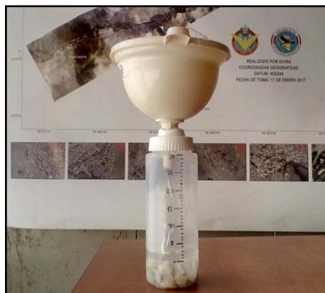
Figure 16. Pluviomètre artisanal fabriqué avec des objets courants promu par le COE-CHOSICA
