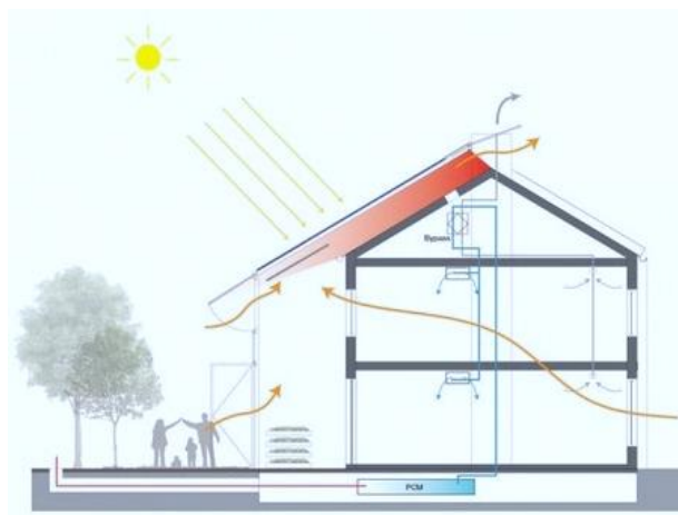
Fig. 26. Schema di ventilazione naturale.
