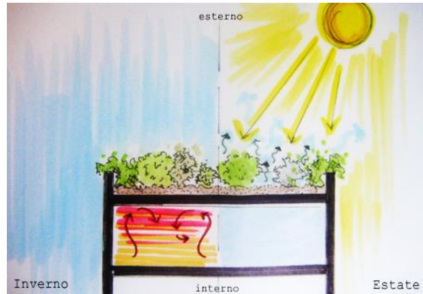
Fig. 9. Funzionamento tetto verde in estate / inverno.
