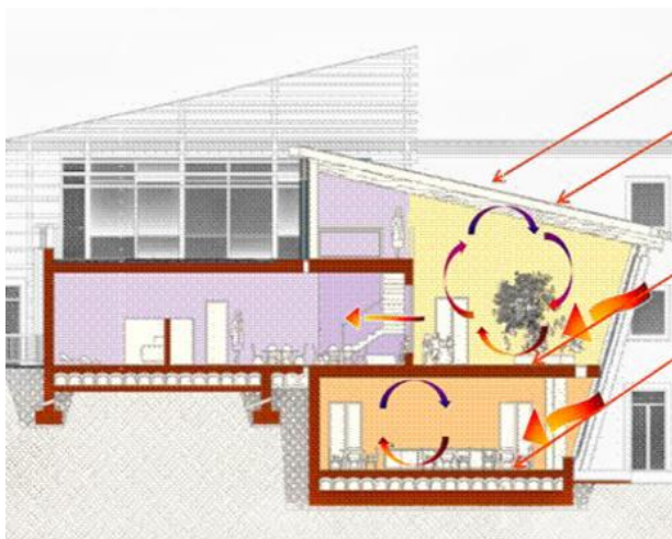
Fig. 22. Serra solare, funzionamento invernale (massa di accumulo termico).
